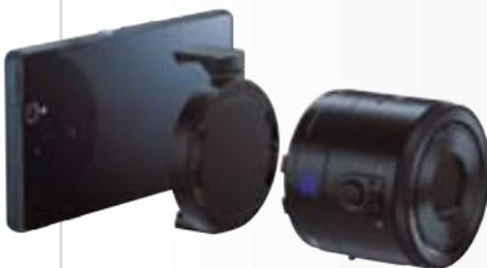
**Aufsteck-Kameras** verwandeln das Smartphone in einen Fotoapparat mit optischem Zoom und hoher Auflösung. Die komplette Technik steckt dabei im Objektiv, das per WLAN mit dem Handy kommuniziert. Als Bildschirm und zum Auslösen dient das Smartphone.
